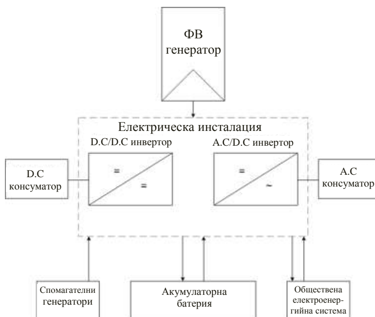
Фиг. 2.20. Структурата на фотоволтаична система
