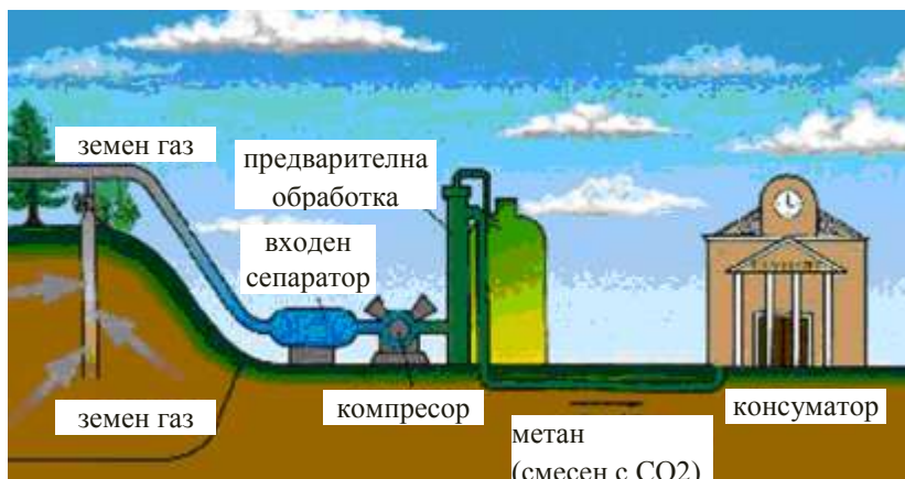
Фиг. 11.3. Инсталация за извличане на сметищен газ (NST Engineers, 2007)
